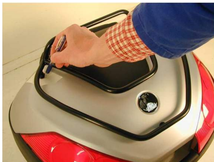
Abb. 2: Markieren der Bohrungen
