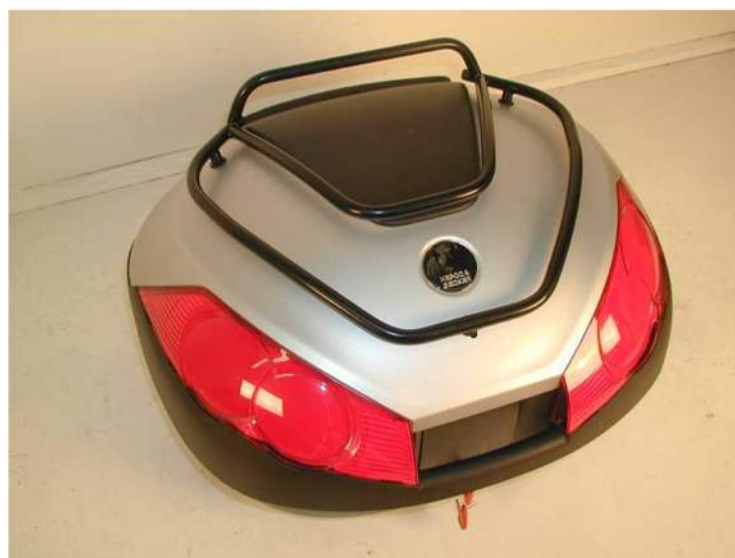
Abb. 4: Fertig montiert, Anzugsmoment 5 NM
