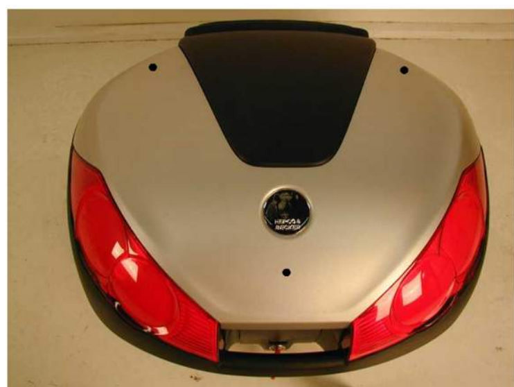
Abb. 3: Topcase mit Bohrbild
