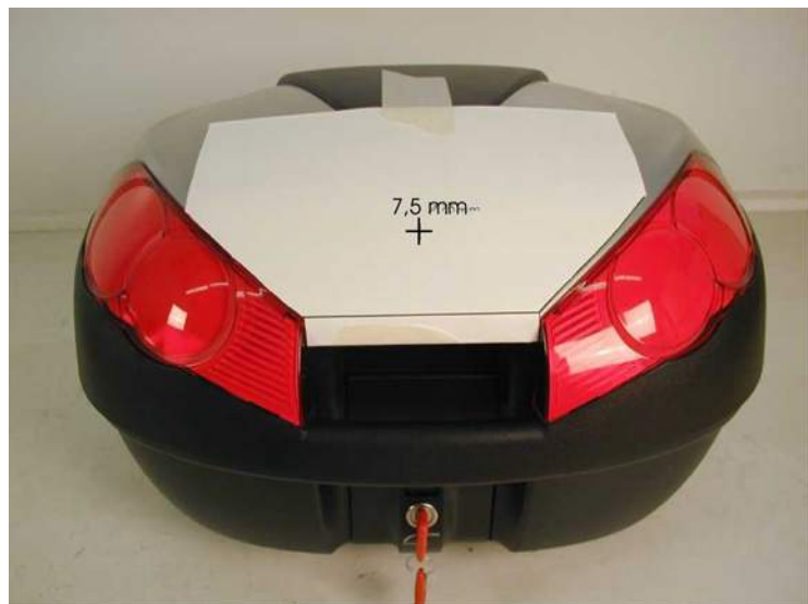
Abb. 1: Anbringen der Bohrschablone
