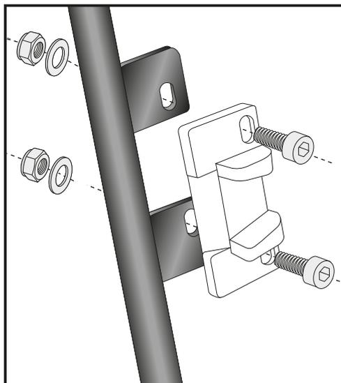
Montage des Metalladapters zum Einhängen des Kofferhalteschlosses
