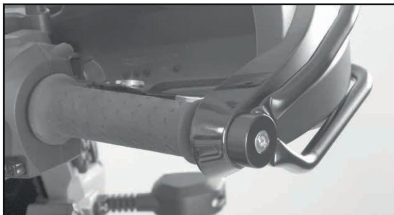
Befestigung des Griffschutzes oben links und rechts:
