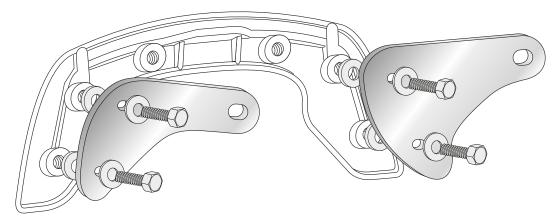
Den C-Bow mit den montierten Halteadaptern an den freien Bohrungen der Chromleiste am Fahrzeug verschrauben. Hierzu die Zylinderschrauben M10 x 90 x 1,25 mit U-Scheiben ø10,5 verwenden. Zwischen Halteadaptern und Chromleiste die Distanzen ø18 x ø11 x 40mm einfügen.
