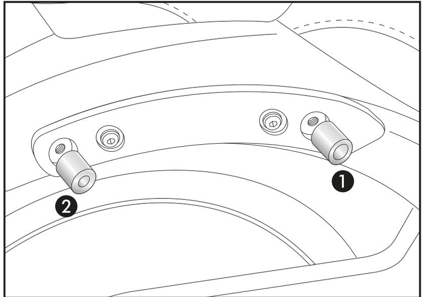
Montage der C-Bows: die vorbereiteten C-Bows werden nun am Motorradrahmen über der Blende verschraubt.
