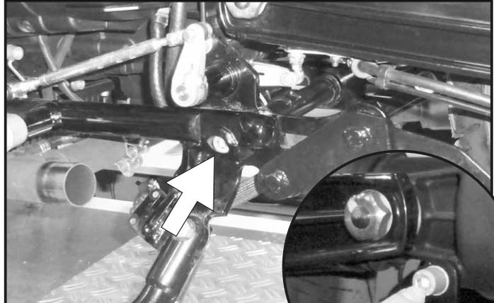
Zum leichteren Ausbau der Rahmentraverse empfehlen wir auf der rechten Seite die Rahmenschraube leicht zu lösen.
