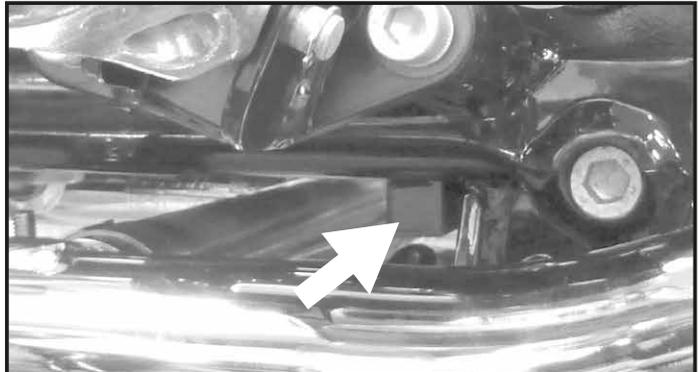
Den Endtopf wieder montieren und alle Schrauben fest anziehen. Den oberen Anschlag an der Sechskantschraube M8x35 einstellen. **Achtung! Schräglagenfreiheit sowie Luftspalt zwischen Endtopf und Ausleger beachten!**
