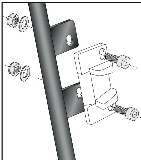
**Montage des Metalladapters zum Einhängen des Kofferhalteschlosses**
