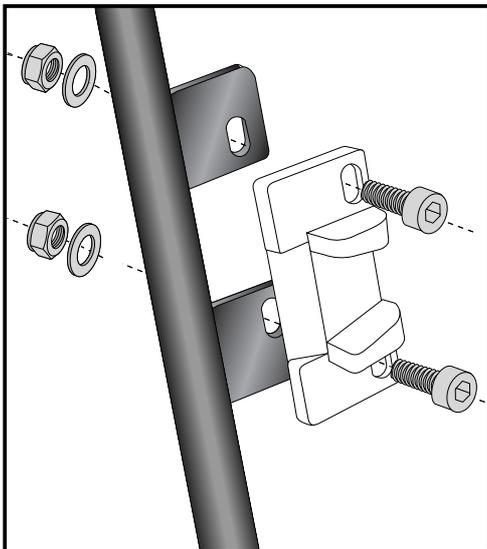
Montage des Metalladapters zum Einhängen des Kofferhalteschlosses
