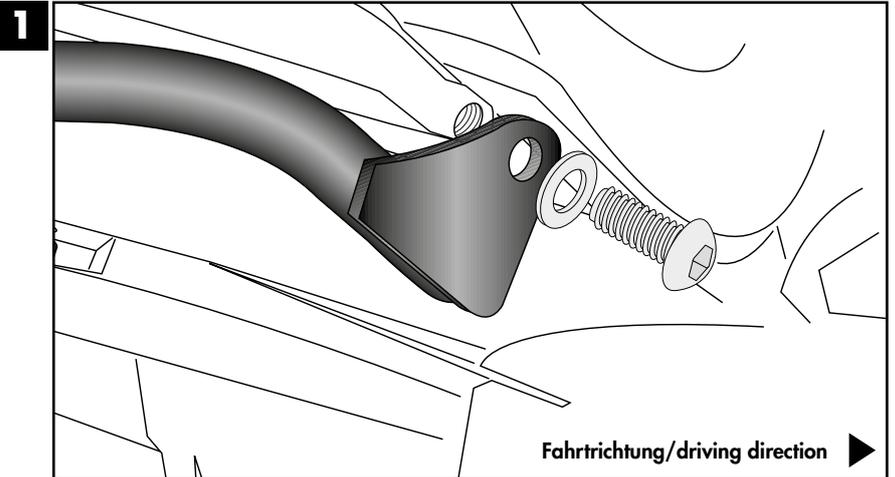
**Montage der Rohradapter rechts/links unten:**
