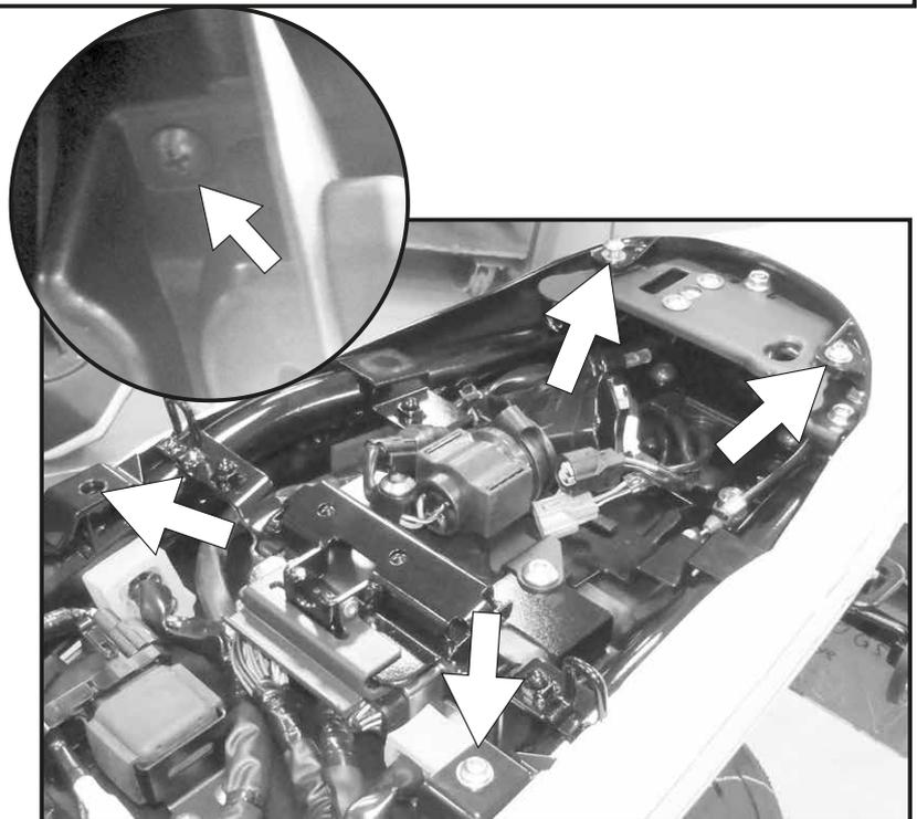
Nun die Schlosstraverse demontieren und die 4 darunterliegenden Linsenschrauben sowie die Kreuzschlitzschraube entfernen und den Kennzeichenhalter entnehmen.
