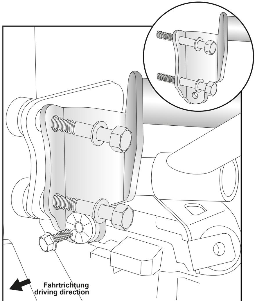
Montage des Motorschutzbügels hinten links:
