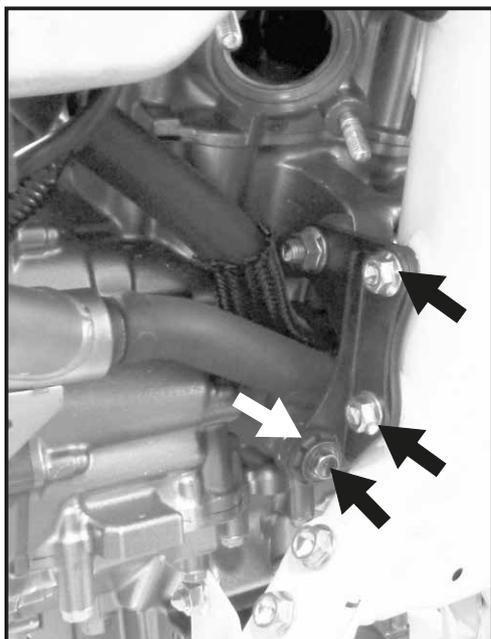
Für die Montage muss der Motorschutz (6 Schrauben) sowie die Auspuffanlage demontiert werden, hierfür vorab die Kunststoff-verkleidung sowie die darunterliegende Katverkleidung entfernen. Nun die Schraube hinten am Endtopf sowie die unter dem Kat entfernen. Anschließend den Stecker der Lambdasonde trennen, vorne die Hutmuttern der Krümmerbefestigung entfernen und die Auspuffanlage entnehmen. Hierbei ist darauf zu achten dass die Dichtringe im Flansch nicht rausfallen.
