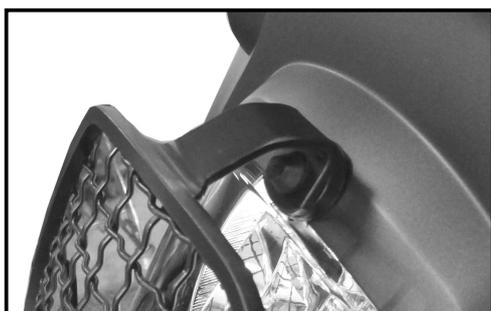
Gummipuffer an der Oberseite einziehen.
