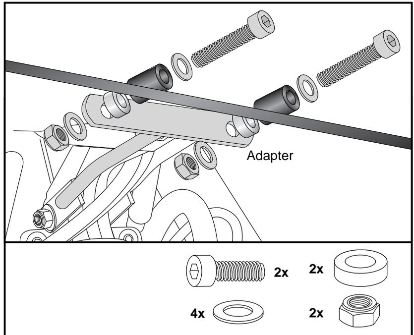
**Montage mit Tankschutzbügel 502 3530 / Assembling with Tank guard 502 3530:**
