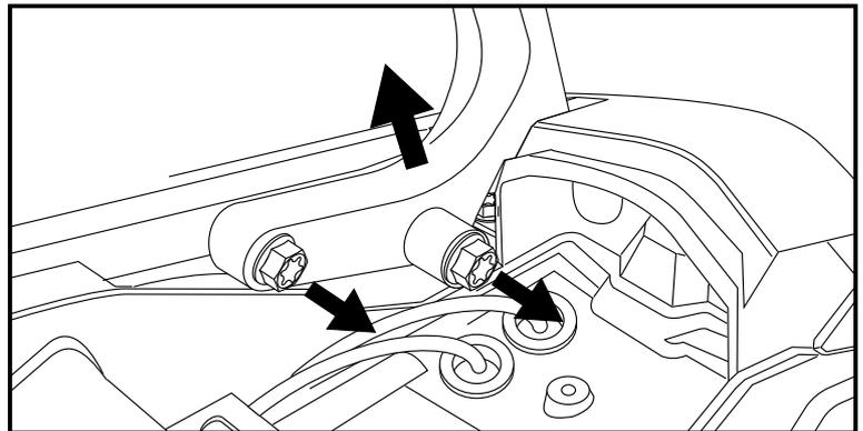
Die beiden Originalschrauben hinten unter dem Heck entfernen, diese entfallen.
