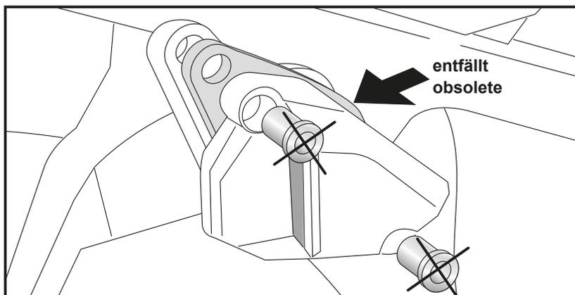
Distanzplatte und die Originalhülsen entfallen. Die Original-Kofferträger-aufnahme wird mit Originalschrauben und U-Scheiben  $\varnothing 8,4$  wieder verschraubt.
