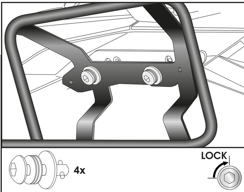
Bei Bedarf (extremer Belastung) können die Kofferträger zusätzlich fest verschraubt werden. Hierzu die Linsenkopfschrauben M8x20 sowie U-Scheiben ø8,4 und Sprengringe ø8,4 verwenden.
