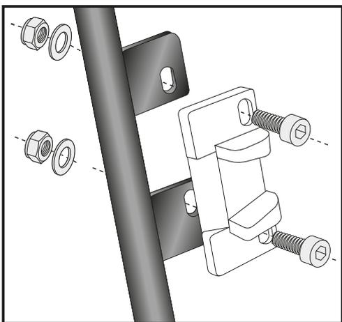
Montage des Metalladapters zum Einhängen des Kofferhalteschlosses
