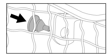
Die beiden Originalschrauben der vorderen Tankschutzbügelbefestigung entfernen, diese entfallen.
