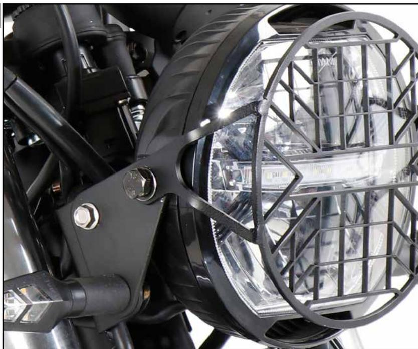
Nach der Montage des Lampengitters muss der Scheinwerfer bzw. die Leuchtweite wieder korrekt ausgerichtet werden.
