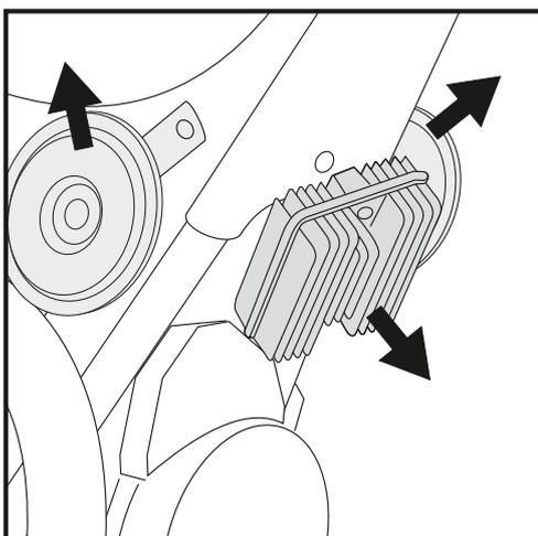
Gleichrichter, Gleichrichterhalterung und Hupen links und rechts demontieren.
