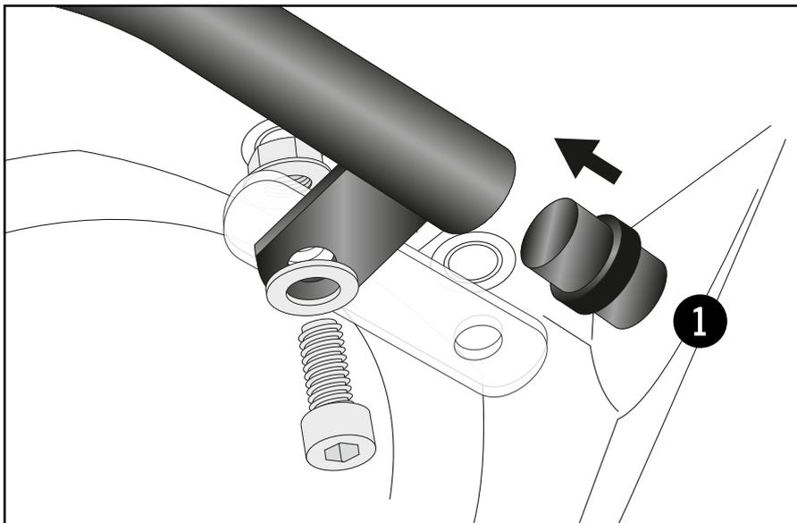
Die Verbindungsstücke Ø25 vorne oben 1 und unten 2 in die Rohr-
