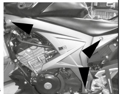
**Montage Motorschutzbügel hinten rechts:**
