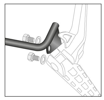
Befestigung des hinteren Halters: Hinten unter dem Heck die beiden Originalschrauben demontieren, diese entfallen.
