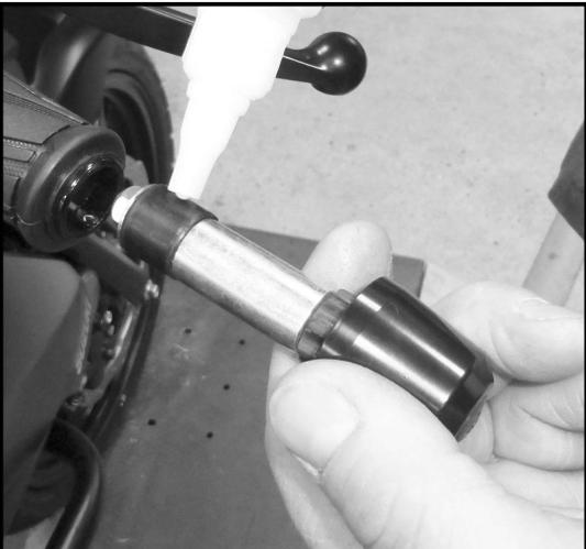
Die beiden Schrauben der Lenkergewichte rechts und links nur lösen (Vorsicht, nur lösen, ansonsten kann die Mutter in den Lenker fallen!) und komplett entnehmen.
