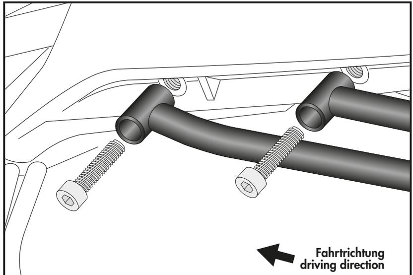
Bei gemeinsamer Montage mit dem C-Bow Halter wird dieser direkt auf den Rohradaptern mit den Linsenkopf-schrauben aus dem C-Bow Schrauben-satz befestigt.
