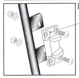
Montage des Metalladapters zum Einhaken des Kofferhalteschlosses
