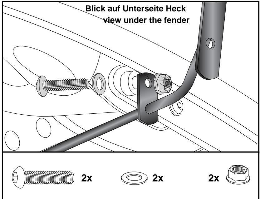
**3** Montage der C-Bow an die Adapter links + rechts:
