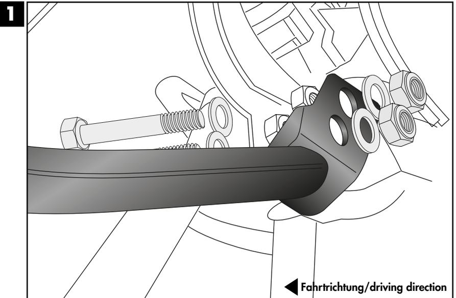
**Befestigung der Tankschutzbügel vorne:**
