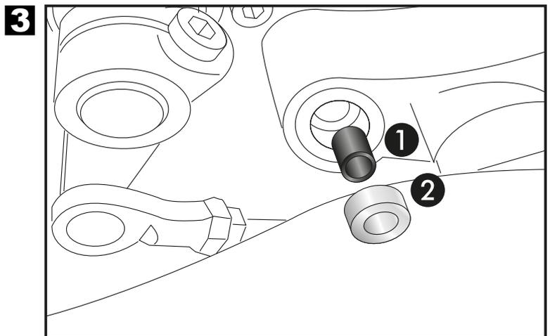
**4** Montage des Motorschutzbügels links hinten:
