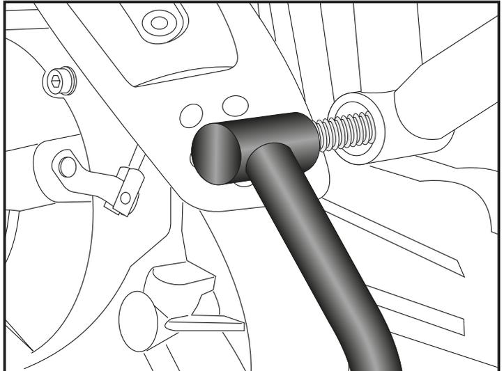
Montage des Motorschutzbügels rechts hinten:
