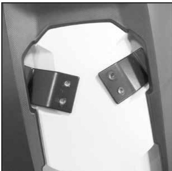
**2** Die Montageplatte wird mithilfe der Haltetaschen unter der Verkleidung verklemmt.
