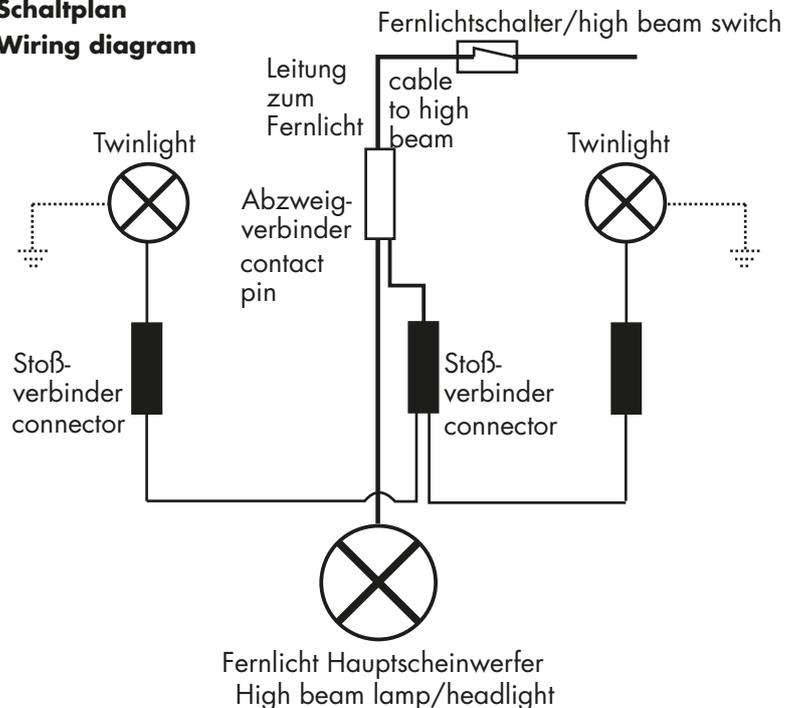
**Bei beschichteten Twinlighthaltern muss eine separate Masseverbindung zum Fahrzeug hergestellt werden!
