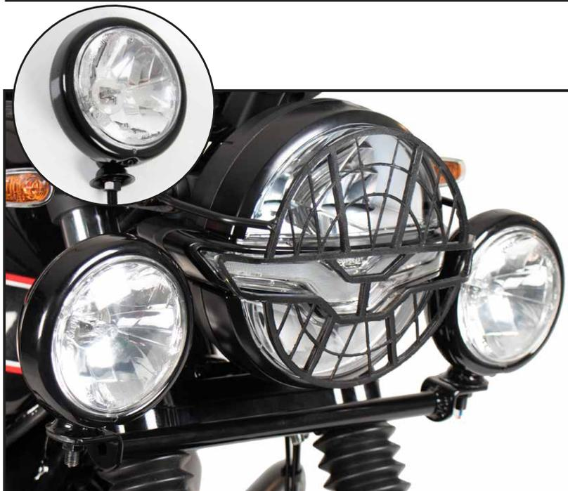
**Je nach werkseitiger Einstellung muss die an den Gabelrohren befindliche Halterung des Hauptscheinwerfers gelöst und dieser nach oben geschoben werden, damit die Blinker nicht verdeckt werden.**
