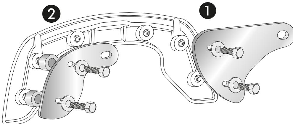
**2** Den C-Bow mit den montierten Halteadaptoren an den freien Bohrungen der Chromleiste am Fahrzeug verschrauben.
