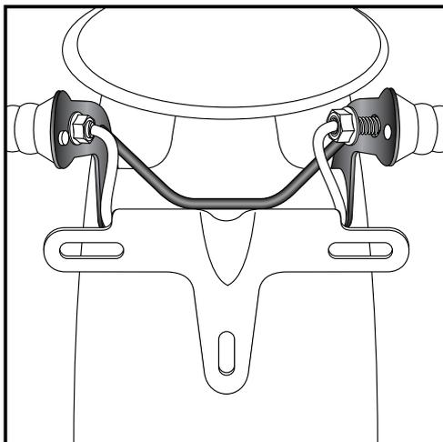
Der mitgelieferte Blinkerhalter wird so positioniert, daß sich die Rundstahlstrebe auf dem Nummernschildhalter abstützt. Die Blinker werden an den runden Seiten der Laschen verschraubt. Die Blinkerkabel müssen nicht verlängert werden. Rücklicht wieder komplett montieren.
