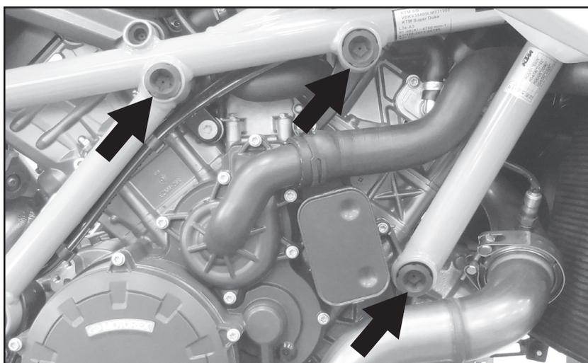
**Montage Motorschutzbügel vorne unten rechts/links:**
