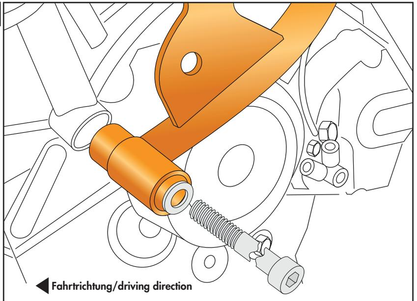
**Montage Motorschutzbügel hinten rechts/links:**
