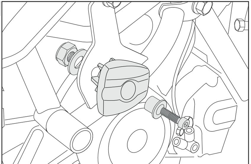
Nach dem Festziehen aller Schrauben, die 2 originalen Gummiabdeckungen in die vorderen Buchsen fügen. Die Abdeckkappen auf die restlichen Schraubenköpfe fügen. Logoblende in das ProtectionPad einsetzen.
