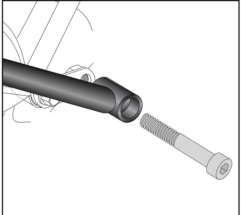
Montage der Tankschutzbügel vorne:
