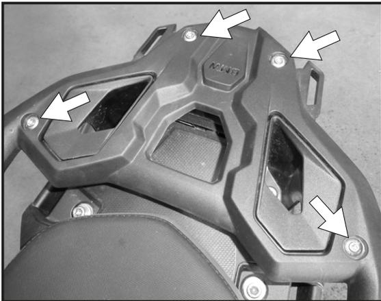
Die 4 Schrauben aus der Originalbrücke entfernen, diese entfallen.
