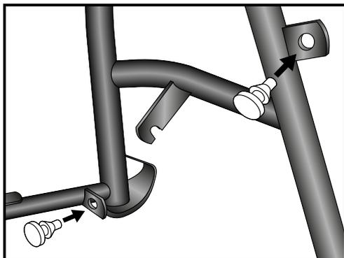
**1** Die Anschlaggummis in die Bohrungen des Hauptständers drücken. Die Montage wird vereinfacht, wenn Sie die Gummis vorher mit Spiritus anfeuchten.
